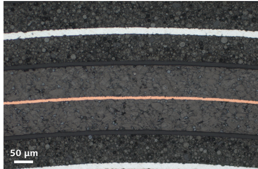
Lithium-Ionen-Batterie, Hellfeld, EC Epiplan 20x/0,4
